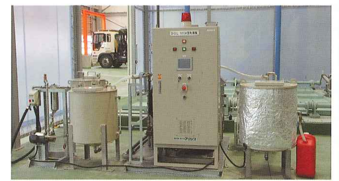
■BDF装置 廃食油からバイオディーゼルをつくります。バイオディーゼルは車の燃料として利用されます。
