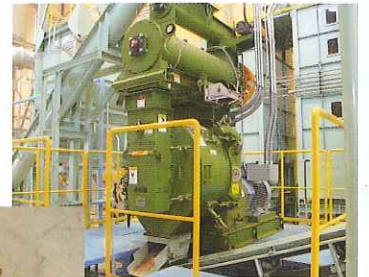
■成形機 投入された木質原料を破砕、乾燥した後、成形し木質ペレットを作ります。
