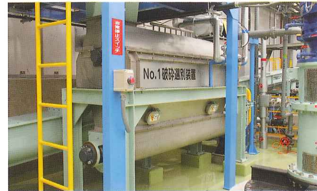
■破砕選別装置 破砕した生ごみを、生ごみと廃プラに選別します。
