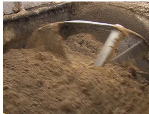
攪拌し微生物により発酵
