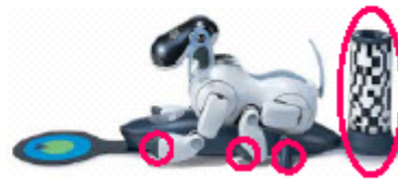
AIBO ERS-7 マーカーベース、足他計5種12部品 2003/11発売(日欧米) 計254g
